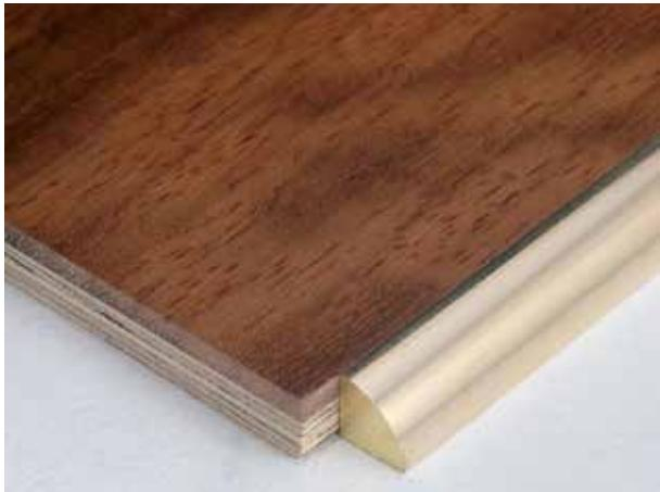
Perfiles de latón extruido de conexión entre pavimentos ya colocados. Piezas de terminación para parquet o cerámica y conexiones entre superficies coplanares de 10 mm de espesor. Permiten resolver rápidamente y con un óptimo resultado estético las situaciones más frecuentes de juntas entre pavimentos de materiales diferentes, donde no se haya previsto un oportuno sistema de conexión en el momento de la colocación.
